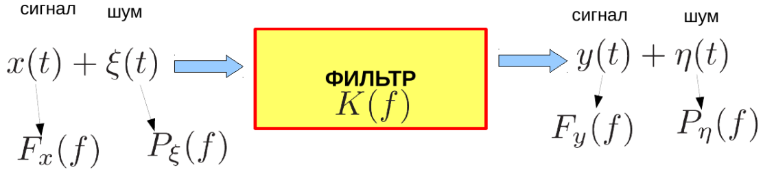
Рисунок 2.2.2: Линейный фильтр, описываемый коэффициентом передачи K(f)
