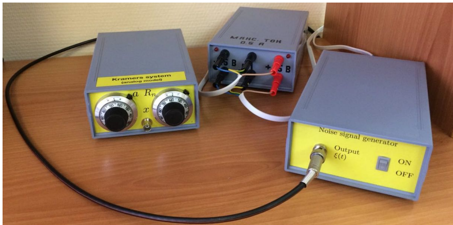
Рисунок 1.4.6: Внешний вид экспериментальной установки в сборе
