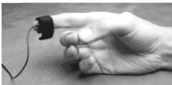
Рис. 5.6. Фотоплетизмографический датчик ТSD200.
